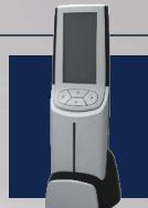
**Cu triplu rol:** cronotermostat digital de ambient, sondă externă de temperatură și stație meteo, Comfort Station reprezintă soluția inteligentă de confort climatic ce furnizează cel mai eficient control al temperaturii din locuință, oferind simultan informații legate de condițiile atmosferice: presiune, temperatură, umiditate, prognoză meteo. Permite programarea pe temperaturi diferite în timpul nopții, al zilei sau în perioada în care nu sunteți acasă.
